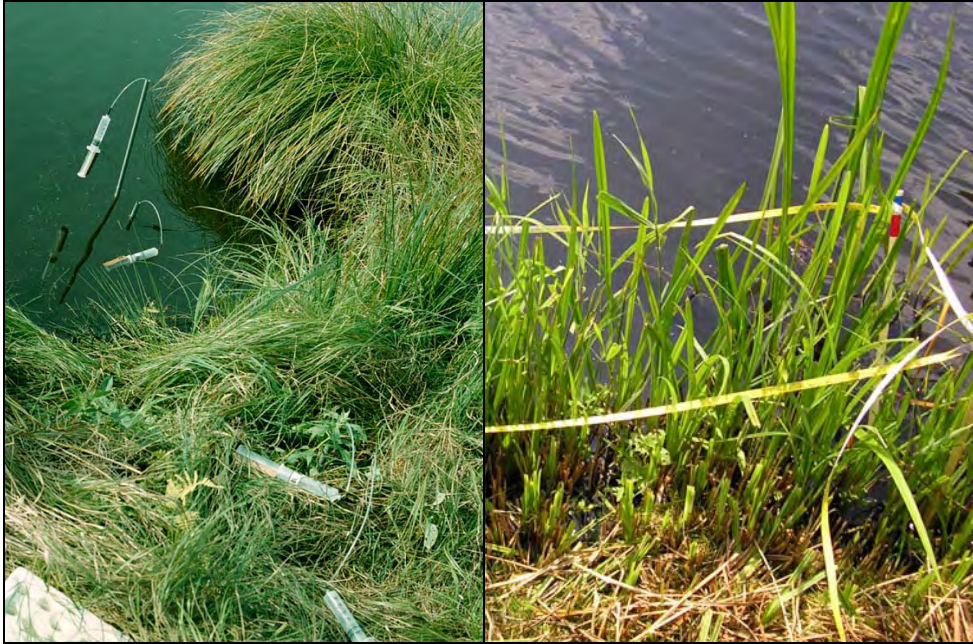
Figuur 8.1 Monsternamen met behulp van keramische cups en vacuüm getrokken spuiten in De Deelen (links). Vegetatie opname in Ilperveld (rechts).
