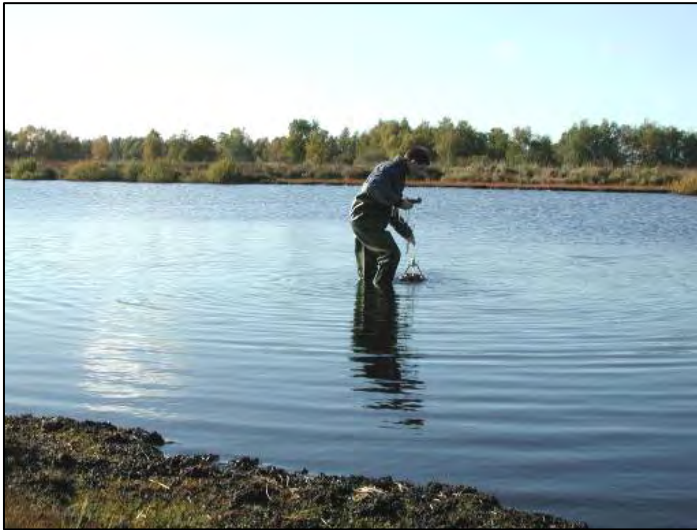
Figuur 4.2 Bodem bemonsteren met een bodemhapper in De Deelen (Foto: Jan v.d. Graaf).
